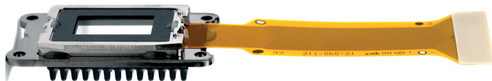
Panely Sony SXRDT™ (červený, zelený a modrý) slouží pro vytvoření špičkového obrazu v kvalitě 1080 Full HD
