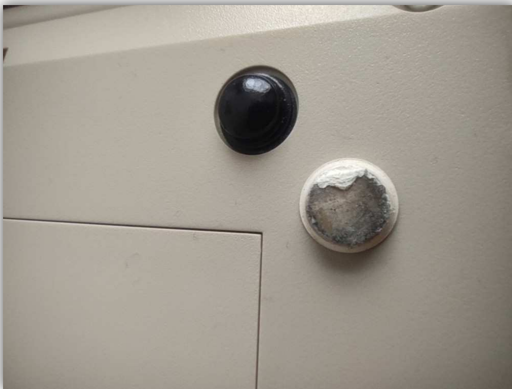
Obrázek 57 - Vyměněná přístrojová nožička
