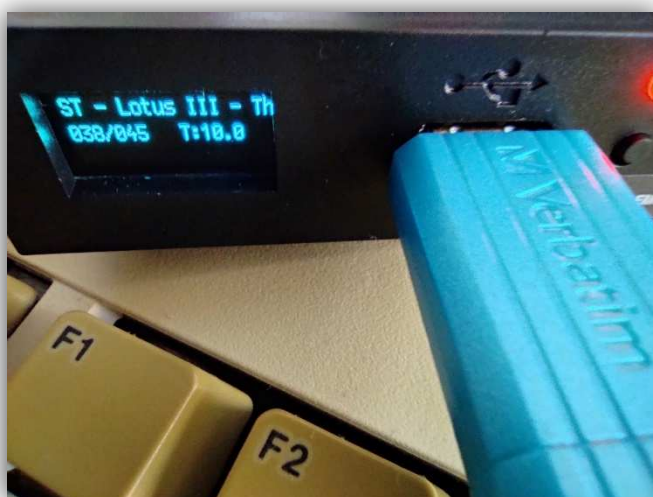
Obrázek 72 - GoTek s načteným obrazem diskety pro počítač Atari ST
