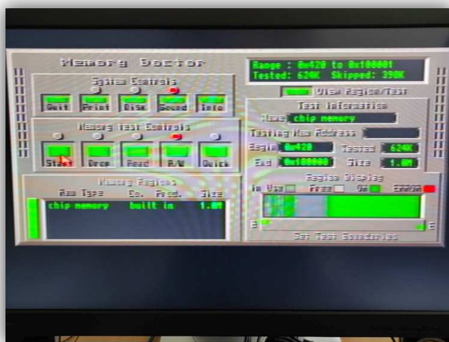
Obrázek 79 - Úspěšný test RAM
