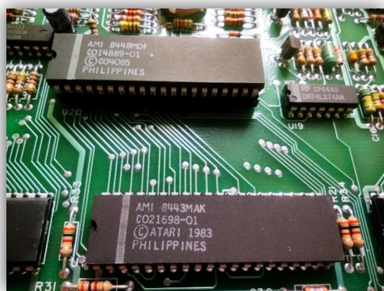
Obrázek 2 - Custom čipy osmistovové série Atari
