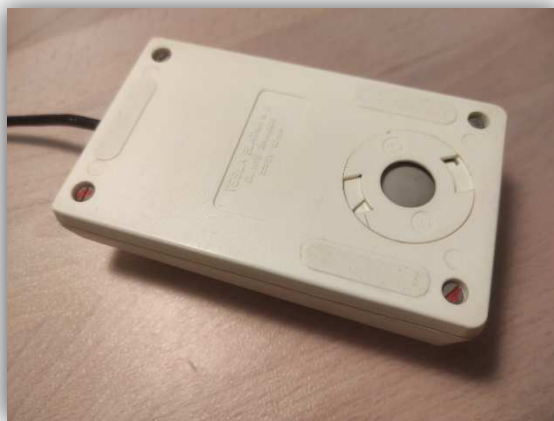
Obrázek 60 - Myš Tesla, kuličkový snímač
