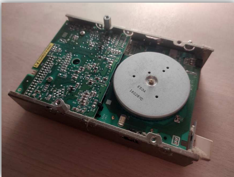
Obrázek 50 - FDD, spodní část s pohonem
