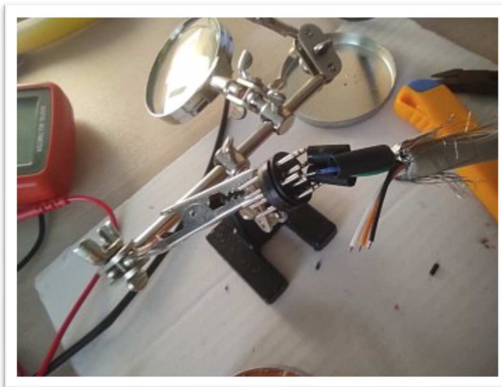
Pájení kabelů - v tomto případě je k tomu velmi užitečný pomocník, tzv. třetí ruka
