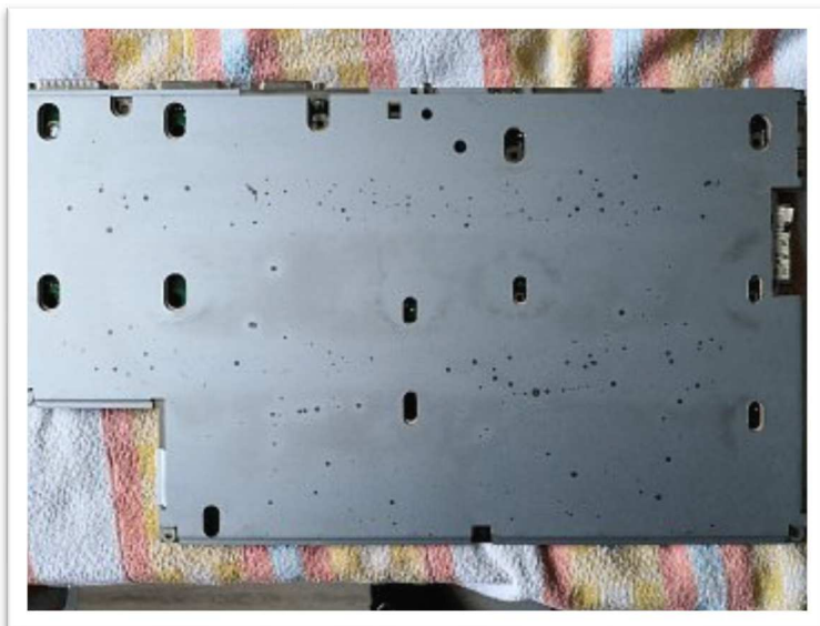
Spodní stínění. Ty tečky po celém povrchu jsou povrchové stopy rzi. Nikde není prerezlo do hloubky.
