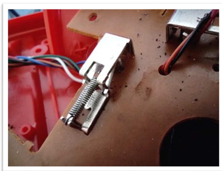
Opravený mikrospínač s novou pružinkou.
