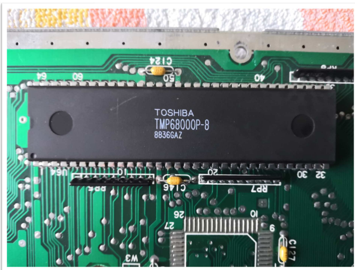
A tady je hlavní čip, samotný procesor Motorola 68k. Zde ho ale vyrobila firma Toshiba.
