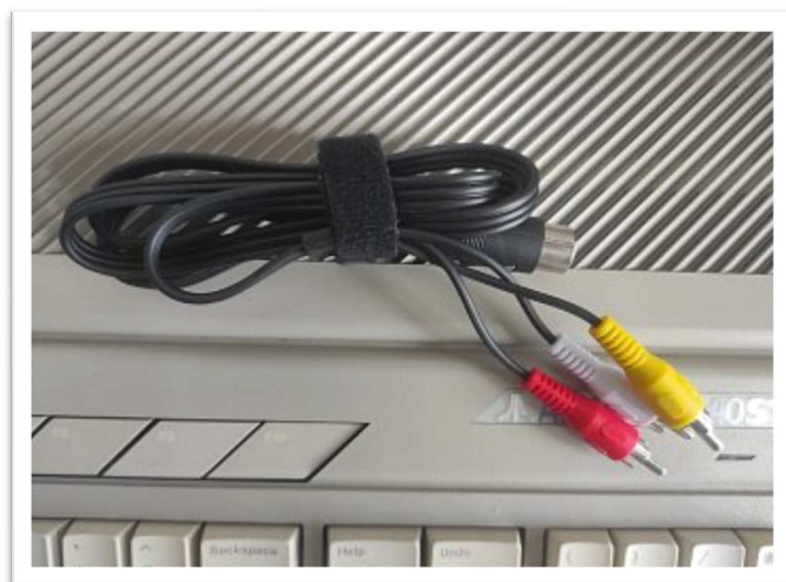
Kompozitní video - zde použit velmi levný kabel, stíněná varianta je lepší kvůli kvalitě signálu
