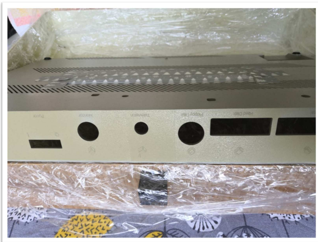
Příprava spodního krytu na sluneční lázeň. Všimněte si světlejších míst, kde bylo světlo kryto (pod konektory a ve spáře).
