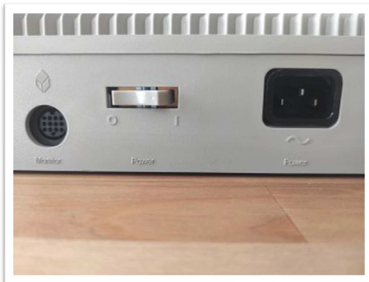
Atari ST - napájení a hlavní vypínač, zároveň zde vidíme 13-pin DIN konektor pro monitor
