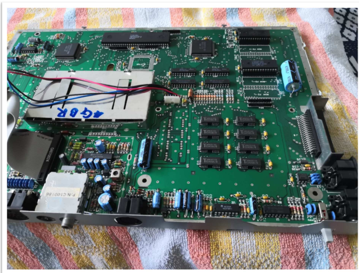
Konektorová část základní desky. Vlevo dole je vidět TV modulátor, napravo pak expanzní konektor a MIDI porty.
