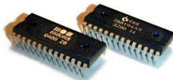
Zvukový čip SID proslavený v počítačích Commodore 64. Jeho typický zvuk pamětníci dokáží rozeznat snad kdykoli. (zdroj: Wikipedia.com)
