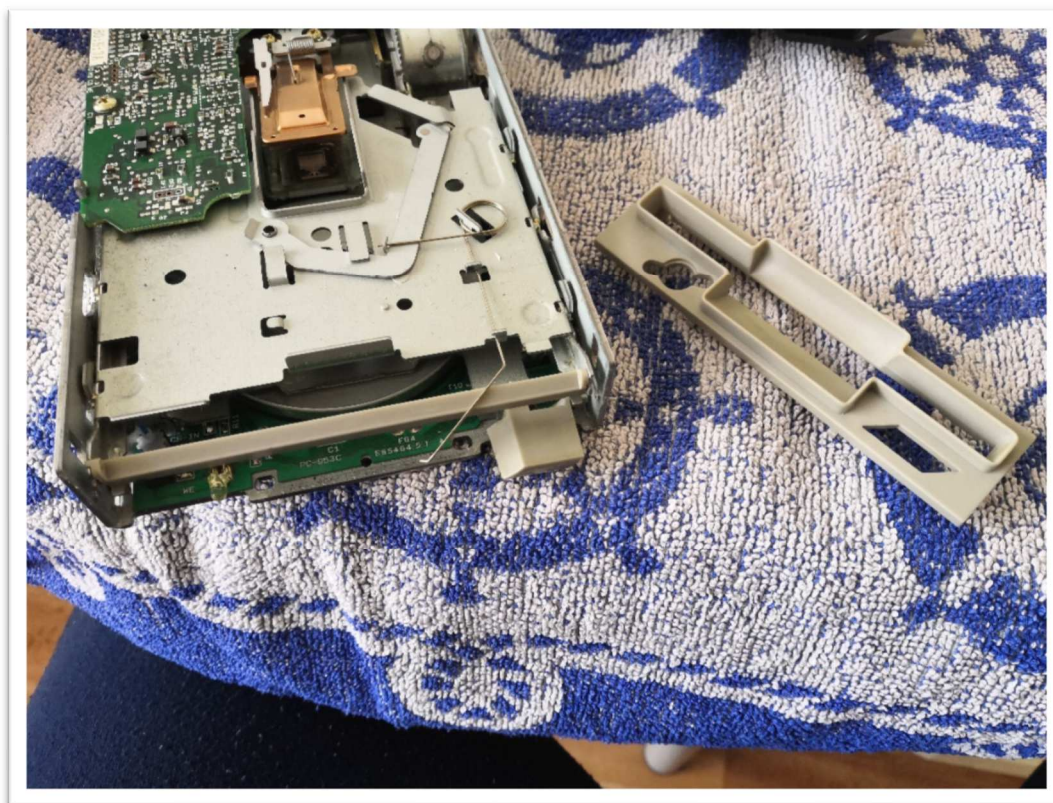
Disketová jednotka bez vrchního krytu a čela. Na ploše je vidět vrstva prachu usazená za ty roky uvnitř. Nicméně nic hrozného.
