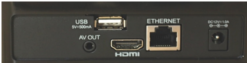
Zadní panel provedení Air (pouze 1x USB, S/PDIF není)
