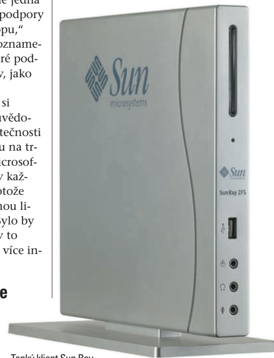
Tenký klient Sun Ray 2FS od společnosti Sun Microsystems nabízí bezpečný přístup či přímé připojení dvou monitorů.
