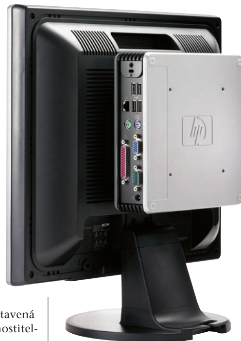
Tenký klient Compaq t5135 společnosti Hewlett-Packard představuje mimo jiné i zajímavé designové řešení – výrobce jej totiž „přilepil“ zezadu k monitoru.
