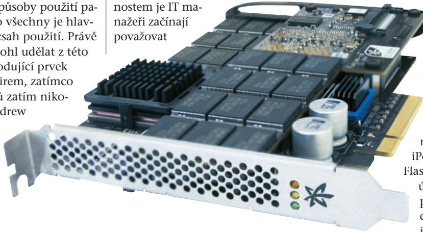
Flash paměť pro výkonné servery nemusí mít jen podobu SSD – jak dokazuje produkt ioDrive Duo od společnosti Fusion-Io, lze jej nainstalovat i do portu PCI Express. Na snímku je 640GB varianta typu MLC, jež nabízí při čtení dat propustnost až 1.4 GB/s, přičemž přístupová latence při čtení činí méně než 80 \mu s.
